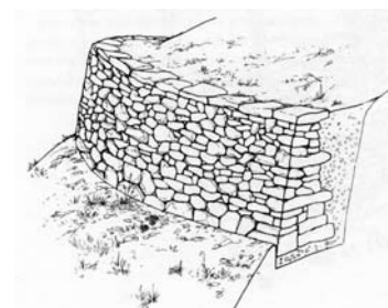
Mur de soutènement construit en pierres sèches, avec un couronnement de dalles (Fondation Actions en Faveur de l'Environnement, 1996, 72).
