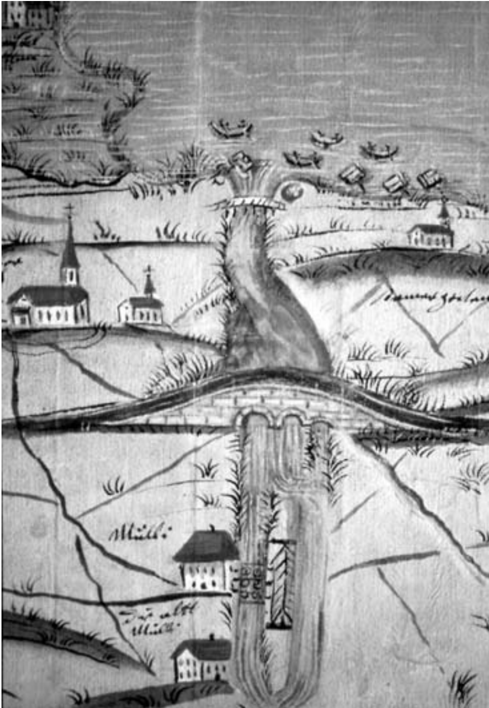
Abb. 2: Beim Neubau der Mühle Oberkirch von 1650–1652 wurden namentlich beim Wehr im Unterbau der damaligen Steinbrücke Anpassungen an den neuen Standort der Mühle vorgenommen. Weil darauf der Abfluss der Suhre aus dem See gestört wurde, kam es zu Überschwemmungen und Klagen. In diesem Zusammenhang ist der abgebildete Situationsplan (Ausschnitt) entstanden. Er stammt vermutlich vom Kartografen Hans Ulrich Wägmann.
