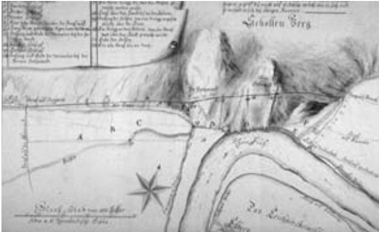
Abb. 65: Ein Plan für die neue Schollbergstrasse von David Anton Stedelin von 1791. Er zeigt neben der alten Schollbergstrasse die vorgeschlagene Hangfuss-Variante an der Howand (D) sowie drei Zugangsvarianten durch die Saar-Ebene (A–C). Dieses Projekt dürfte auch Vorbild für die Anlage der Staatsstrasse von 1822 gewesen sein. (SG 3.2)
