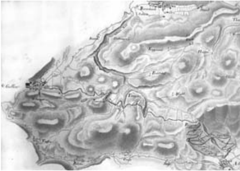
Abb. 10: Der Projektvorschlag von Ingenieur Alois Negrelli von 1836. Schön erkennbar sind die vielen Schleifen, um eine geringe Steigung zu erhalten. Dadurch wurde die Strecke viel länger als die Stossstrasse, ganz unten im Bild. (ZBZ Kartensamml.: 4 JI 45: 1 und 11 JI 46: 1)
