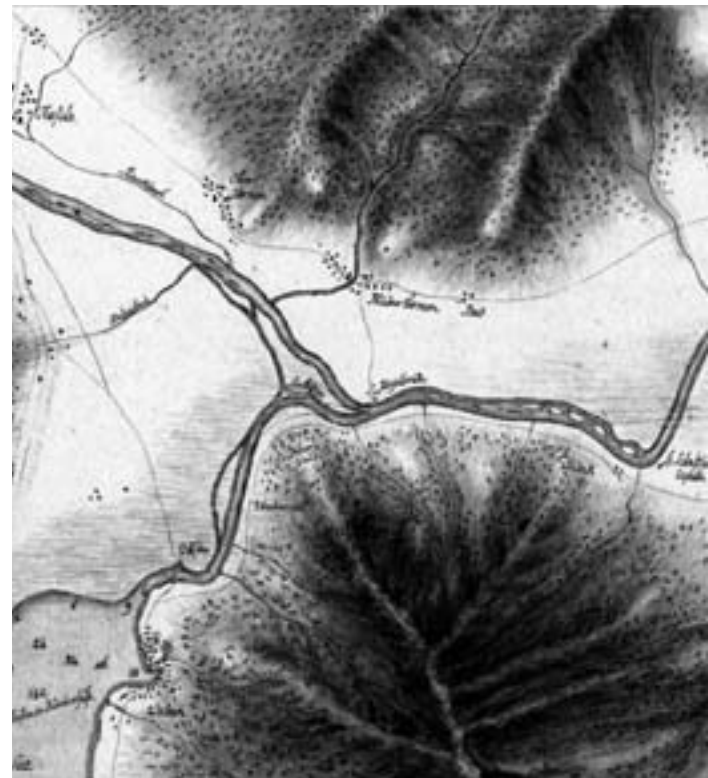
Der Verlauf der Linth zwischen Walensee und Zürichsee. Das projektierte neue Linthbett ist mit feinen Linien eingetragen. Zeichnung von Hans Conrad Escher, 1804.
